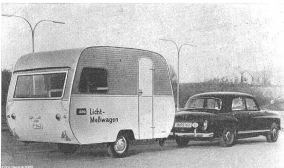
Dieser voll ausgerüstete Meßstand, der nicht an eine bestimmte Versuchsstrasse gebunden ist, dient sowohl für den Transport als auch zur Aufbewahrung des wertvollen Instrumentariums, das für lichttechnische Untersuchungen auf der Strasse notwendig ist. Hierzu gehören u. a.: Beleuchtungsstärkemesser mit kardanischer Aufhängung zum Ermitteln des horizontalen und vertikalen Beleuchtungsstärkeverlaufes, physikalische und visuelle Leuchtdichtemesser zum Bestimmen des Leuchtdichteniveaus und
