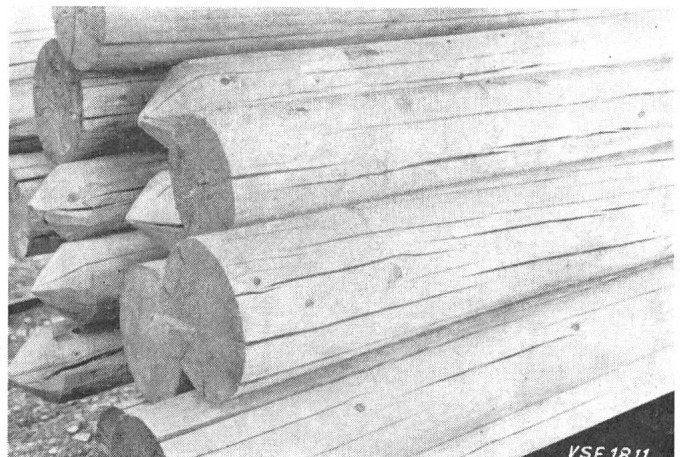
Fig. 2 Masten nach der Trocknung im Ofen. Das Holz ist durch den Trockenprozess aufgerissen worden.
