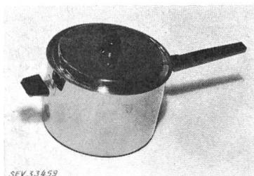
hat bei der Formbeständigkeitsprüfung nur eine kleine Deformation erlitten. Solche Kasserollen sind somit für Verwendung auf elektrischen Herden geeignet.
