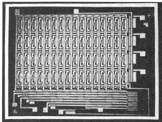
Das Planar-II-Verfahren verhindert die Ionen-Konzentration in der Siliziumoxyd-Zwischenschicht. Hierdurch werden Kanaleffekte vermieden, welche auftreten, wenn eine entsprechend hohe Ladung im Silizium-Kristall an der Grenzschicht zum Siliziumoxyd hin entsteht. Auf Grund des Planar-II-Verfahrens sind Ionen innerhalb der Oxydschicht nur noch in einem unvermeidbaren minimalen Umfang vorhanden. Sie sind nicht frei beweglich, sondern als Oberflächenladung blockiert.
