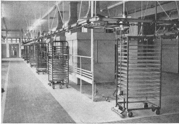
In manchen Fällen können dank einem Kreisförderer sogar alle vier Postulate gleichzeitig erfüllt werden. In vielen Fabrikationsprozessen bilden Kreisförderer konventioneller Bauart, als Schleppbahnen oder als POWER- AND FREE-Förderer die Grundlage einer rationellen Produktion. Aber auch Probleme der Lagerung, Zwischenlagerung oder Speicherung bieten interessante Aufgaben für dieses vielseitige Fördersystem.
