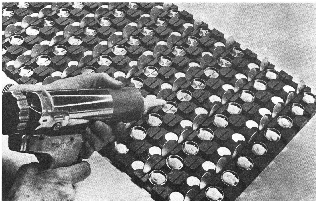
Auftragen einer Wärmeableitungsmasse aus Silicon auf ein Unterwasser-Horchgerät mittels einer Druckluftpistole
