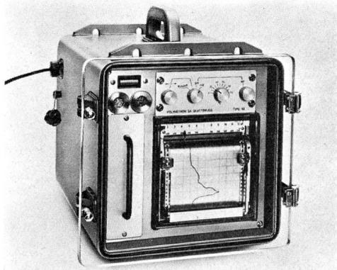
trisch aufgezogen. Eingebaute Trocknungspatronen dienen dem Schutze vor Kondenswasserbildung. Der jeweilige Ladezustand der steckbaren Batterie ist am eingebauten Kontrollinstrument ersichtlich. Ergänzt durch geeignete Messwertgeber, z. B. mit Schwimmerkörper für Kanalisationen, gibt dieser Linienschreiber Aufschluss über den pH- oder Redoxpotentialverlauf in Gewässern oder an Schlüsselstellen der chemischen Verfahrenstechnik.
