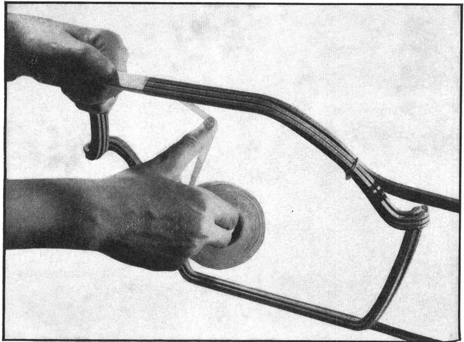
Das thermohärtbare Glasseide-Samicaband SAMICATHERM erlaubt bei einfachster Verarbeitung — von Hand oder mit der Bandwickelmaschine — die Herstellung von Isolationen mit hervorragenden Eigenschaften.
