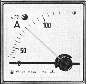
Bimetall-Strommesser (96 × 96 mm)
