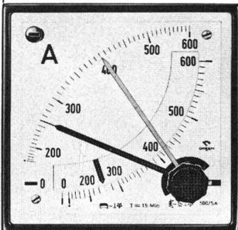
Kombinierter Bimetall-Dreheisen-Strommesser (96 × 96 mm)
