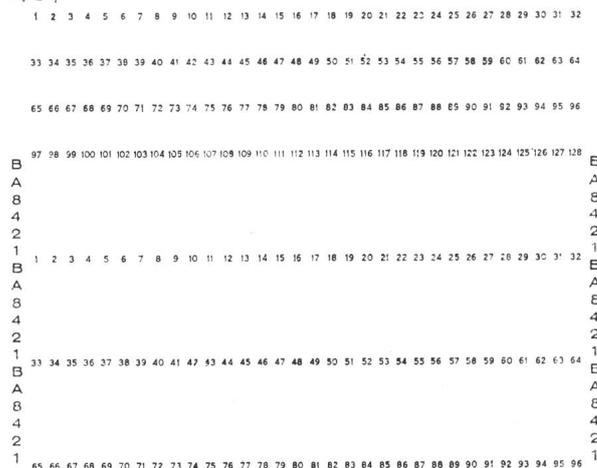
positionen gestatten die Lochung von 64 verschiedenen Zeichen. Die neue Mehrfunktionskarteneinheit liest, stanz, vergleicht, mischt, beschriftet und sortiert die Lochkarten. Das gleichzeitige Lesen bzw. Lochen von 3 übereinanderliegenden Kolonnen ergeben im Vergleich zur mechanischen Bewegung der Karte eine 3mal höhere Datenübertragungsgeschwindigkeit.
