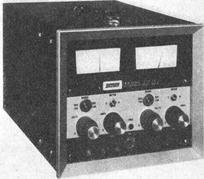
trägt  $\pm 0,005\%$ , diejenige des Stromes  $\pm (0,1\% + 125 \mu A)$ . Die Regelzeit beträgt 50  $\mu$ s (70  $\mu$ s bei Hochgeschwindigkeits-Arbeitsweise) für die Rückkehr zu einer Regelgenauigkeit von  $\pm 10$  mV nach einer Laständerung von Null- zu Vollast oder von Voll- zu Nullast.
