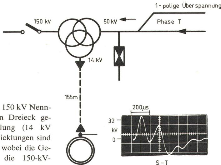
nungswicklungen (50 und 150 kV Nennspannungen) und eine in Dreieck geschaltete Generatorwicklung (14 kV Nennspannung). Diese Wicklungen sind konzentrisch angeordnet, wobei die Generatorwicklung innen, die 150-kV-Wicklung aussen liegt.
