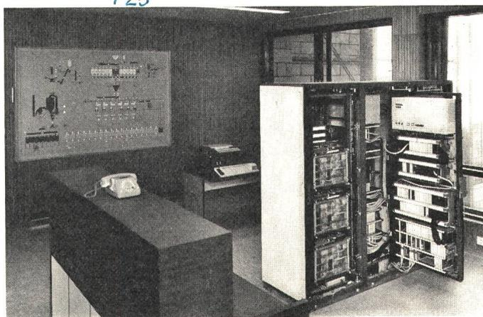
**Prozessrechner in der Porzellanindustrie.** In Schmelitz bei Tirschenreuth (Oberpfalz) errichteten die Porzellanfabriken Lorenz Hutschenreuther AG eine zentrale Aufbereitungsanlage für keramische Massen. Dieses Projekt ist die erste vollautomatische, von einem Prozessrechner gesteuerte Masseaufbereitungsanlage in der Porzellanindustrie. Die Porzellanmasse wird in dieser Anlage nicht mehr in plastilintartiger Form hergestellt, sondern als «Porzellan-Pulver».
