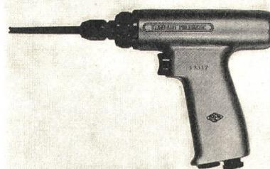
Werkzeug ist die Wickelpistole, Typ 663, zu nennen. Sie zeichnet sich aus durch ihre grosse Arbeitsgeschwindigkeit. Ein einfacher, zwangsläufig gesteuerter Mechanismus kann auf eine von acht möglichen Positionen eingestellt werden und erleichtert das Einführen der Drähte. Dadurch wird der Arbeitsvorgang praktisch zu einer Reflexhandlung. Der Luftaustritt erfolgt durch den Handgriff und reduziert den Geräuschpegel beträchtlich, vor allem aber die unangenehmen hohen Töne.
