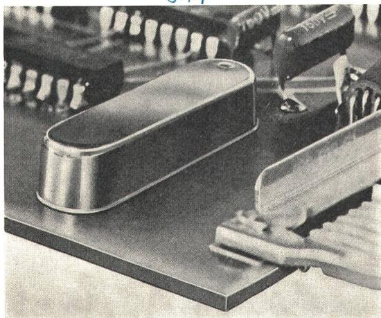
interessanten Abmessungen (38 x 11 mm, 8 mm hoch) preislich günstiger zu stehen kommt als die unter Glas montierten Einheiten. (Ebauches S. A., Neuchâtel)
