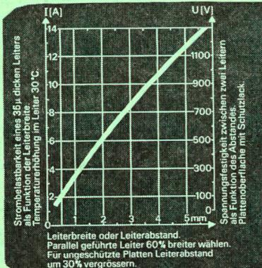
**Richtwerte für gedruckte Verdrahtungen**
