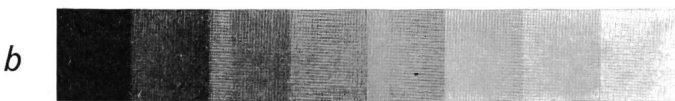
Fig. 5 Erzeugung von Grautönen auf dem Drucker a Zeichenkombination b Grautonkeil (photographische Reproduktion) N Anzahl Grautonstufen M Anzahl übereinandergedruckter Zeichen
