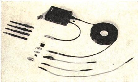
Eine neue Mikro-Miniatursonde von Philips löst nun diese Probleme. Die Sonde besteht aus einem Gehäuse (in dem sich die aktive Kompensationsschaltung befindet), einem 2,5 m langen, leichten flexiblen Kabel sowie speziellen Adaptern, mit denen man die Sonde z. B. kurzschlussfrei an die Anschlußstifte eines «dual in line»-Gehäuses oder an «mini wire wrap»-Stifte anschließen kann.
