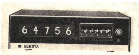
das bestehende und vielfach bewährte Programm an elektronischen Vorwahl- und Messzählern völlig überarbeitet und dem neuesten Stand der Technik angepasst. Das neue, nur 66 mm hohe Gehäuse wurde so gestaltet, dass es sowohl als Tischgerät als auch für den Einbau in Schränke und Tableaux verwendet werden kann. Ausserdem ist die Kombination von mehreren Geräten sehr einfach möglich. Der Schaltungsaufbau erfolgte in modernster IC-Technik. Der Betriebs- und Störsicherheit
