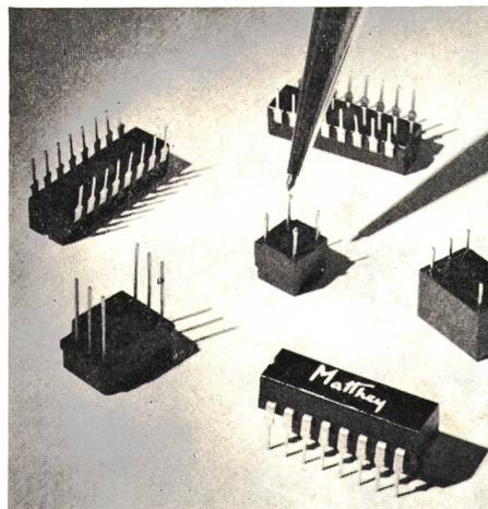
der einen vielseitigen Baugruppen-Service bieten. Die Impulstransformatoren können an den Ausgangspolen bis zu 5 W abgeben; die Primärinduktivität liegt zwischen 10  $\mu$ H und 10 mH.
