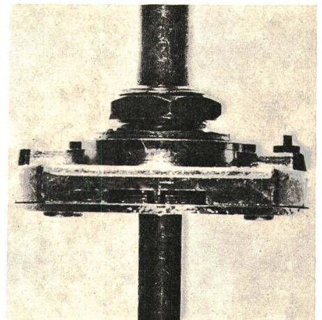
gleichen Rastwerk. Dieses ist mit 2-Kugelverriegelung mit Spiral-Druckfedern ausgerüstet. Praktisch alle Drehschalter der Baureihen M und H können damit bestückt werden.
