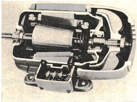
Federdruckbremse nach dem Verschiebläuferprinzip sind. Sie werden als Käfig-, Schleifring- und Gleichstrommotor ausgeführt.
