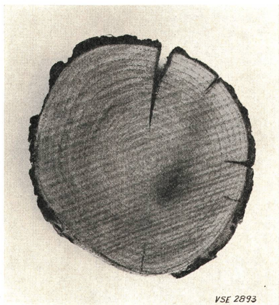
Fig. 5 Rundholz mit dunkelbraun gefärbter und durch Moderfäule zerstörter Mantelzone.
