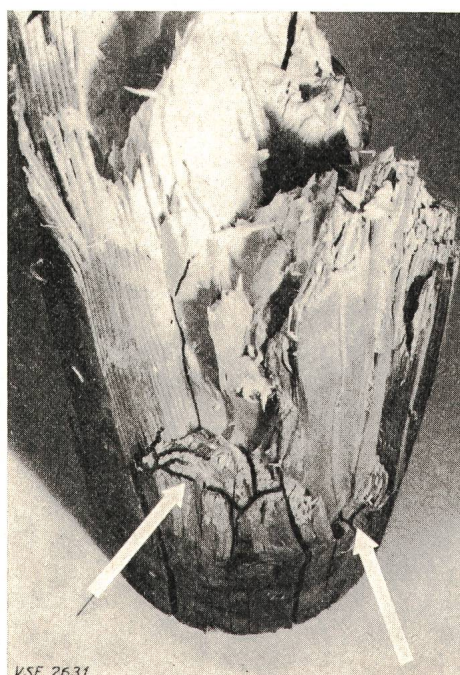
Fig. 7 Bruchzone mit fächerförmig verzweigten Gangsystemen des Nutzholzborkenkäfers ( Xyloterus lineatus ).
