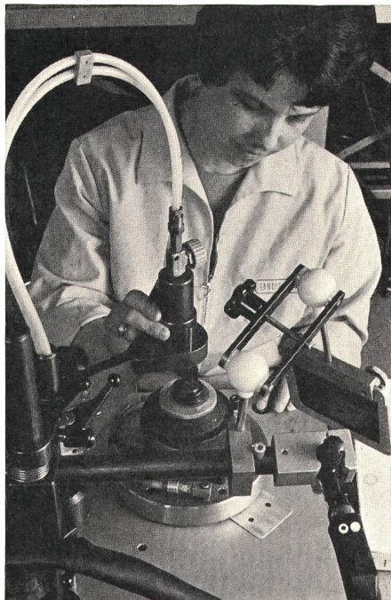
Fig. 12 Ansicht einer halbautomatischen Drehvorrichtung mit MP-Brenner-Schutzschild und pneumatischer Presse
