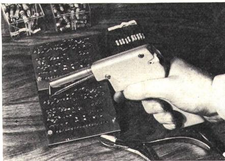
durch die Heizpatrone an der Lötspitze abgefühlt. Die schnell ansprechbare Elektronik erreicht engste Toleranzen der Temperaturschwankung.
