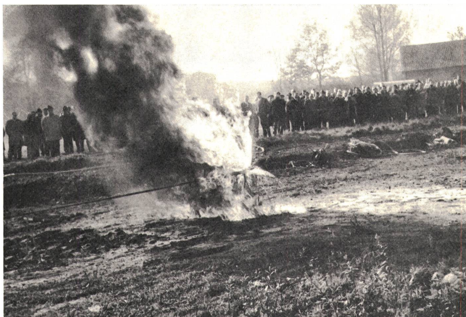
Löschversuch bei geplatzter Benzinleitung Dispositif d'essai avec une conduite de benzine percée
