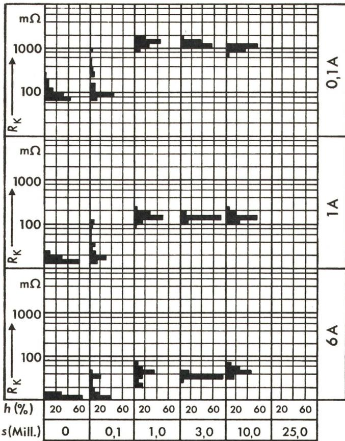
**Fig. 10** Relative Häufigkeit  $h$  der gemessenen Werte der Kontaktwiderstände  $R_K$  bei verschiedenen Meßströmen in Abhängigkeit von der durchgeführten Anzahl Schaltungen  $s$ , Steuerschütz *A*
