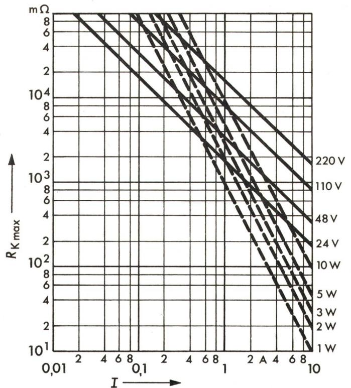
Fig. 2 Grenzwerte des Kontaktwiderstandes in Abhängigkeit vom Strom
