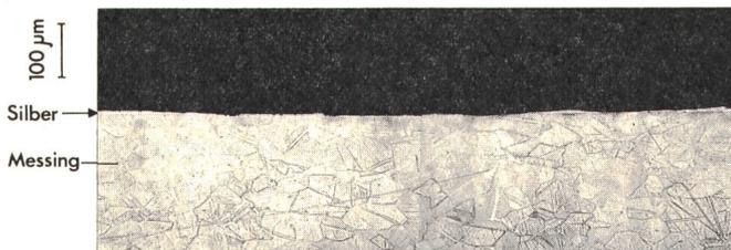
Fig. 5 Übergangsstelle eines versilberten (4  $\mu\text{m}$ ) Messingkontaktes eines Kontakteinsatzes nach 25 Mill. Schaltungen
