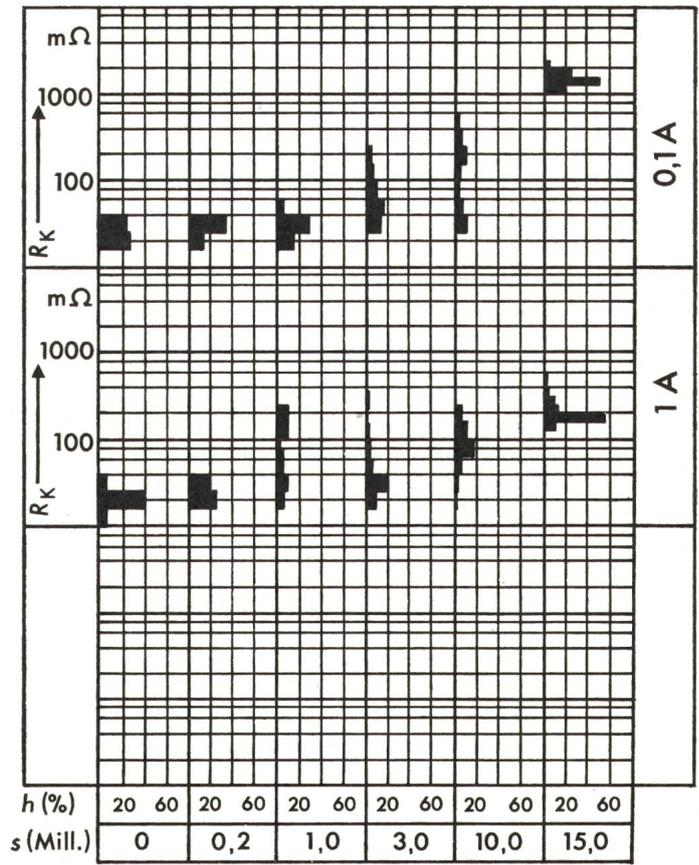
**Fig. 11** Relative Häufigkeit  $h$  der gemessenen Werte der Kontaktwiderstände  $R_K$  bei verschiedenen Meßströmen in Abhängigkeit von der durchgeführten Anzahl Schaltungen  $s$ , Steuerschütz *B*
