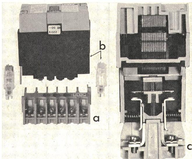
Fig. 4 Baugruppen des Steuerschützes B
