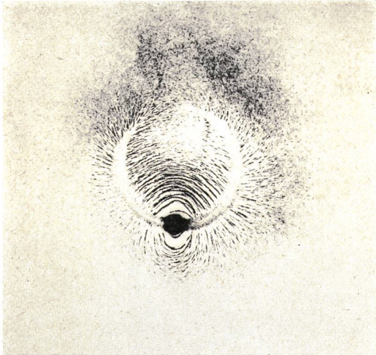
Fig. 10 Eisenpulverbild eines Ringmagneten mit Luftspalt
