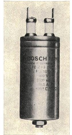
deshalb geeignet zum Betrieb an trapezförmigen Spannungen mit grosser Flankensteilheit, die hohe Stromspitzen zur Folge haben. Die Kondensatoren sind erhältlich in Grössen von 0,1 bis 300 µF für 80 bis 8000 V Scheitelspannung bei Blindleistungen von einigen var bis etwa 200 kvar pro Gehäuse.
