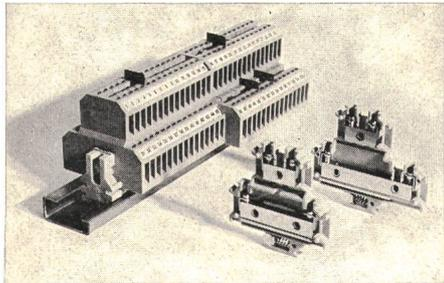
halb so breit wie normale 4-mm<sup>2</sup>-Schmal-klemmen: die Effektivteilung beträgt nämlich bloss 2,6 mm. Dieser minimale Wert wird erreicht durch die seitlich versetzte Anordnung des oberen Stockwerkes.
