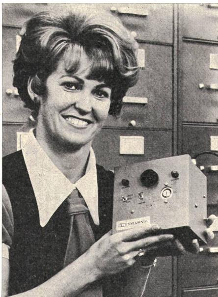
schränke, Aktenschränke und Schreibtische löst bei Annäherung Unbefugter auf 60 cm vom geschützten Gegenstand sowie bei Durchschneiden des Kabels oder Elektrizitätsunterbruch Alarm aus.
