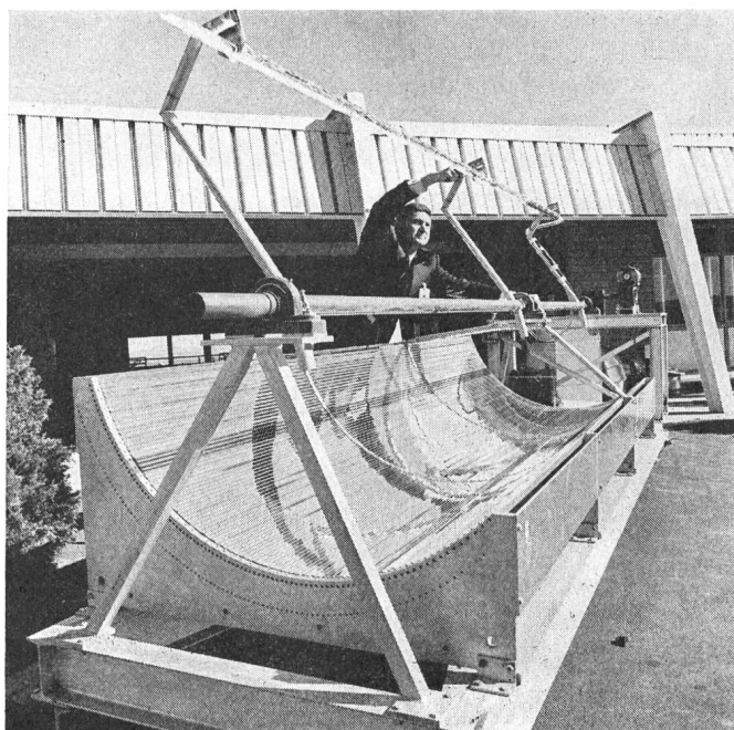
Fig. 4 Versuchsmodell des Sonnenspiegels
