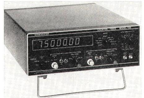
Ein Read Only Memory (ROM) steuert die Funktion, den Dezimalpunkt sowie die zugehörige Einheit. Der Z-Ausgang erlaubt die Beobachtung der Triggerschwelle des Modells 150 an einem Oszilloskop. Dank der hohen Eingangsempfindlichkeit von 10 mV an 1 MΩ Eingangsimpedanz können auch kleinste Signale ohne Zwischenverstärker direkt gemessen werden. Für den Anschluss eines ebenfalls lieferbaren Druckers ist ein BCD-Ausgang vorgesehen.
