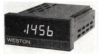
der Dual-Slope-Integrationstechnik von *Weston* zur Umwandlung von Analogsignalen in digitale Form. Aus dieser Methode resultiert gute Langzeitstabilität und die hohe Genauigkeit von ± 0,05 % bei Umsetzgeschwindigkeiten bis 25 Messungen pro Sekunde. Von besonderer Bedeutung für viele Anwendungen sind der asymmetrische oder Differentialeingang sowie der vollisolierte BCD-Ausgang, also der galvanisch vollständig getrennte Schaltungsaufbau.
