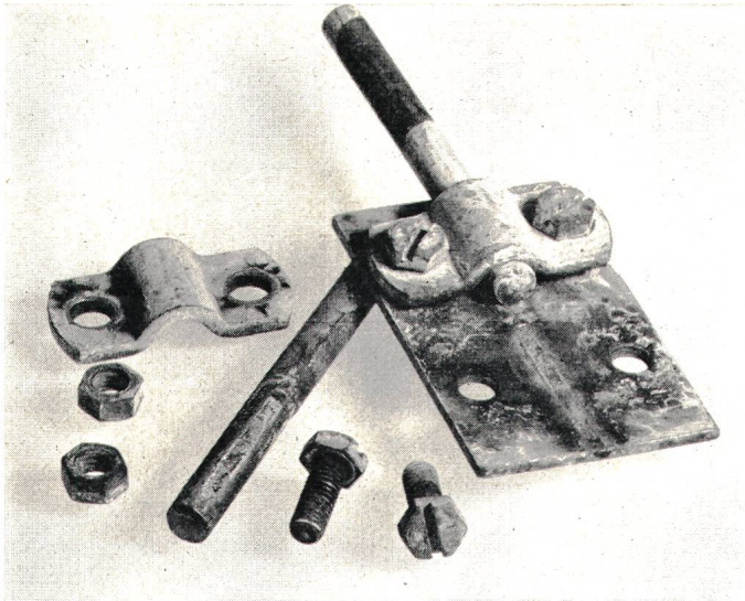
Fig. 10 Künstlich gealterte Stahlverbindung des Typs 1 der Fig. 9 nach der Prüfstrombeanspruchung
