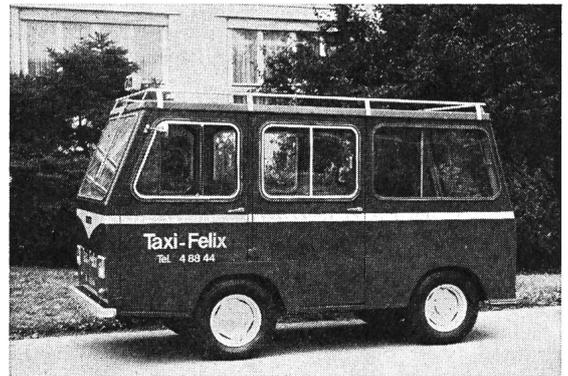
schen. Die 48-V/280-Ah-Traktionsbatterien von 700 kg machen rund die Hälfte des gesamten Fahrzeuggewichtes aus. Eine einfache Vorrichtung erlaubt es, die leeren Batterien relativ rasch gegen geladene auszutauschen. Das Elektrofahrzeug wird von 2 48-V-Seriemotoren von je 4 kW Nennleistung angetrieben, die über Thyristoren stufenlos gespeist werden. Es fährt sich wie ein gewöhnlicher Personenwagen mit automatischem Getriebe, wobei aber mit dem «Gaspedal» die Fahrgeschwindigkeit vorgegeben wird. Eb
