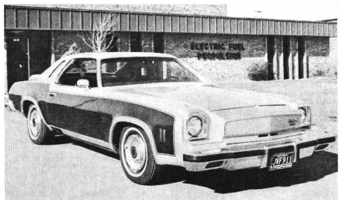
Fig. 11 Luxus-Personenwagen «Transformer 1» Max. Geschwindigkeit: 110 km/h (bei ausgeschalteter Klimaanlage) Beschleunigung auf 55 km/h in 8 Sekunden Reichweite ohne Zwischenaufladung: 160 km Aufladedauer der Blei-Kobalt-Batterien: 45 Minuten (80 %)
