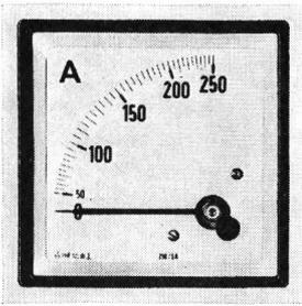
mit einer 240°-Skala sind als V-, A-, W- und Var- sowie Cosphi-Meter in allen DIN-Größen 48, 72, 96 und 144 mm erhältlich, die Bimetall-A-Meter allerdings nur in den Dimensionen 72, 96 und 144 mm. Alle Instrumente können mit Grenzwertkontakten geliefert werden.
