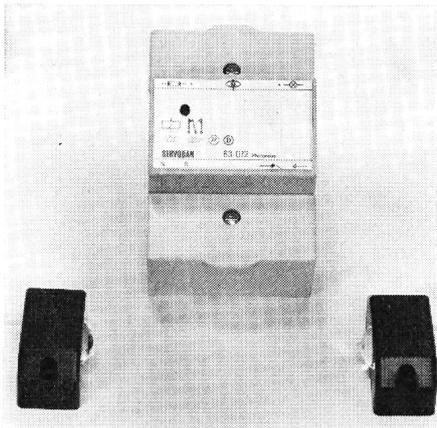
Lichtstrahl, die Unempfindlichkeit gegen Erschütterungen und Fremdlicht sowie die Lebensdauer des Senders von über 50 000 h ergeben ein Produkt, das die meisten bisher verwendeten Lichtschranke-systeme ersetzt. Die Reichweite dieser Lichtschranke beträgt 10 m. Das Gehäuse des Relais ist für AP- oder DIN-Schiennenmontage geeignet. Die komplette Installation, bestehend aus Sender, Empfänger, Relais mit Klemmenabdeckungen, ist erhältlich bei *Buttschardt Electronic AG*, 4002 Basel.
