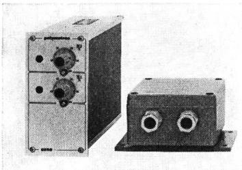
entfernt liegen kann, ohne dass dabei ein entscheidender Messfehler auftritt. Das System besteht darin, dass die Meßschaltung in einem separaten spritzwasserdichten Vorschaltgerät untergebracht ist, welches direkt bei der Meßstelle montiert wird.
