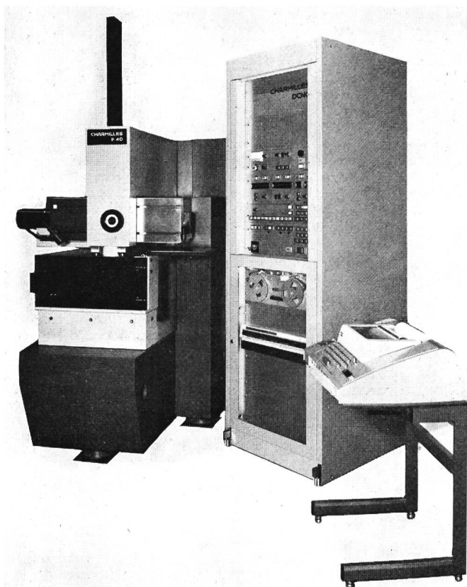
Fig. 4 Machine pour la mise en œuvre du principe du découpage par fil
