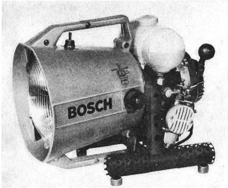
Der Lichtaustritt des Scheinwerfers hat einen Durchmesser von 175 mm; er erreicht eine Beleuchtungsstärke von 500 Lux in 10 m und noch 100 Lux in 23 m Entfernung. Der Strom wird in einem sechspoligen, von Dauermagneten erregten und an den Motor angeflanschten Generator von 150 W Leistung erzeugt. Das leicht transportable Flutlicht-Kleinkraftwerk dürfte vor allem für Polizei, Feuerwehren und Rettungsdienste, aber auch für Industriebetriebe und Werke von Nutzen sein. (Robert Bosch AG, 8021 Zürich)
