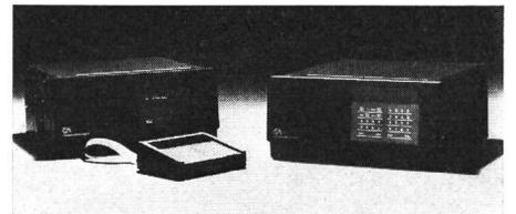
Hauptspeicher für 64 K-Worte, Vectored Interrupts im Real-Time-Betrieb, 145 Instruktionen und eine Zugriffszeit auf den Hauptspeicher (RAM) von nur 550 ns.
