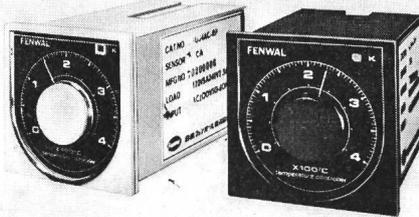
Als Reglerfunktion umfasst diese Reglergeneration wahlweise zeitproportional oder Ein/Aus, und als Fühler können NTC, Pt 100 oder Thermoelemente verwendet werden. (Bachofen AG, 8610 Uster)
