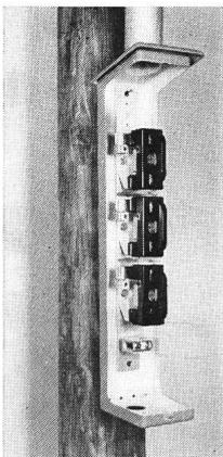
werkstelligt wurde. Der bisher verwendete Sicherungskasten mit nebeneinander angeordneten Sicherungselementen hat aber den Nachteil, dass er breiter ist als der Durchmesser seines Befestigungsmastes und deshalb mechanischen Beschädigungen ausgesetzt ist. Deshalb wurde von *Rauscher & Stoecklin AG*, 4450 Sissach, ein sehr schmaler Strang-Sicherungskasten, 500 V, 250 A, aus glasfaserverstärktem
