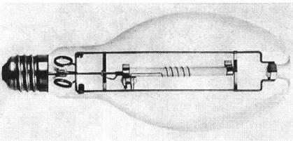
der Zündspirale und der Elektrode am unteren Ende des Brenners. Federnde Halterungen schützen den Brenner im Betrieb gegen Stösse. Mit einer Leistung von 350 W gibt die Lampe 34 000 Lumen ab, gegenüber 23 000 Lumen, die mit einer 400-W-Hg-Dampf Lampe erreicht werden.
