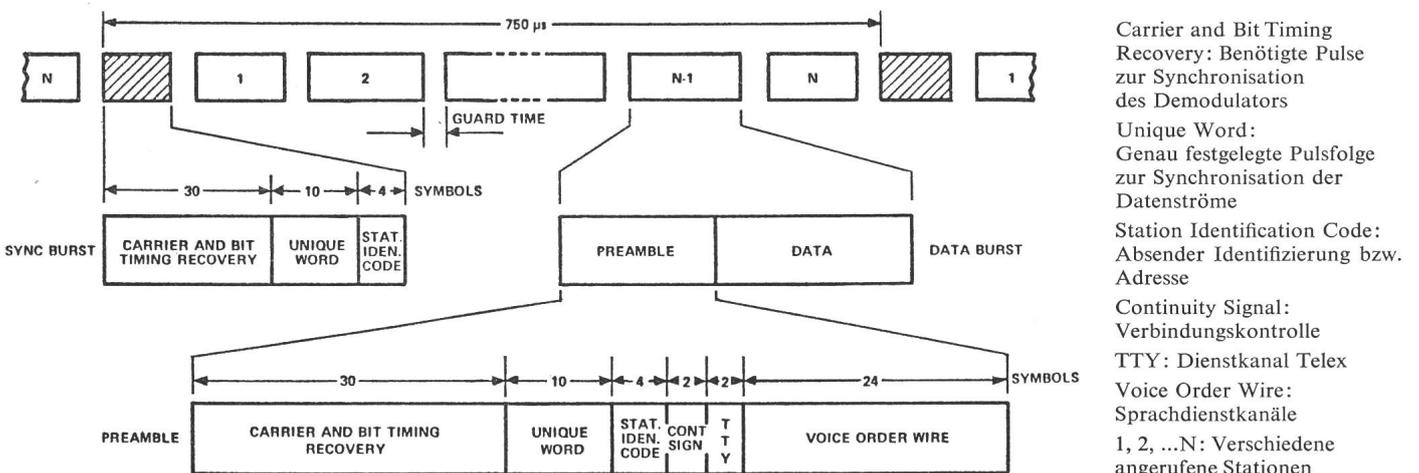
**Fig. 2 Typisches TDMA-Rahmen-Format**
