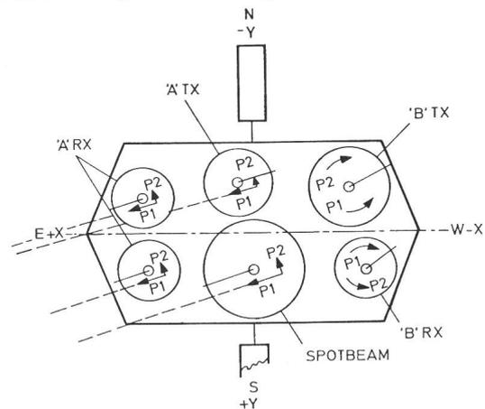
Fig. 7 OTS-Antennen-Anordnung
