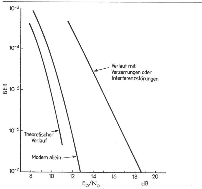
**Fig. 1 TDMA-PSK-Fehlerratenmessung**
