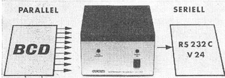
gungseinrichtungen, Tischrechner, Mini-computer und Magnetaufzeichnungsgeräte angeschlossen werden. Bei Bedarf kann der Anschluss auch über eine im Interface verfügbare 20-mA-Stromschleife erfolgen.
