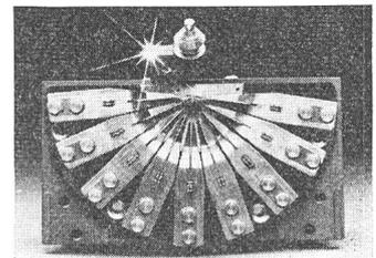
Dank diesem Verfahren konnte ein äusserst kompakter und leichter Druckkopf entwickelt werden, der 250 Z/s schreibt. Die Lebensdauer entspricht 500 Mio Zeichen, was bei normaler Anwendung in ca. 5 Jahren erreicht wird. Da keine mechanischen Justagen notwendig sind, ist der Kopf absolut wartungsfrei. Er stellt sich auf die Anzahl Kopien automatisch ein.
