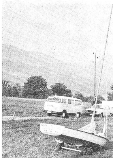
Fig. 4 Dieses Segelboot wurde auf dem Rollschemel über Land gezogen und geriet mit dem Mast in eine Freileitung
