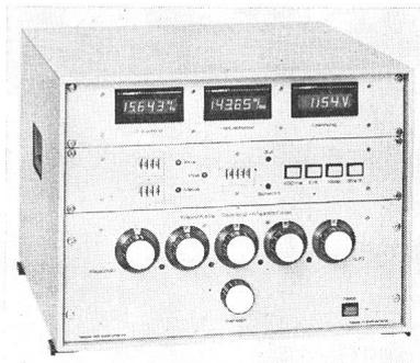
zeigt an, ob die Kapazitäts-Toleranz C plus oder minus überschritten ist oder ob der Verlustfaktor zu gross ist. Die Messzeit beträgt 2,5 s (resp. 600 ms bei reduzierter Genauigkeit).
