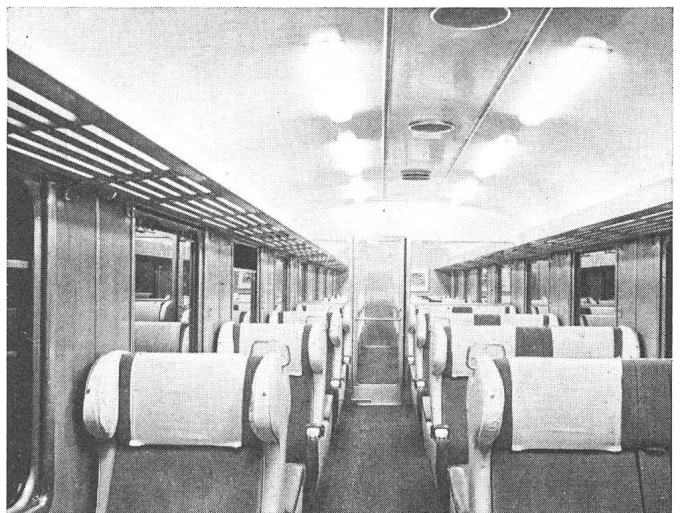
Fig. 6 Anordnung der Fluoreszenzleuchten im Grossraum des SBB-Einheitswagens II (A)
