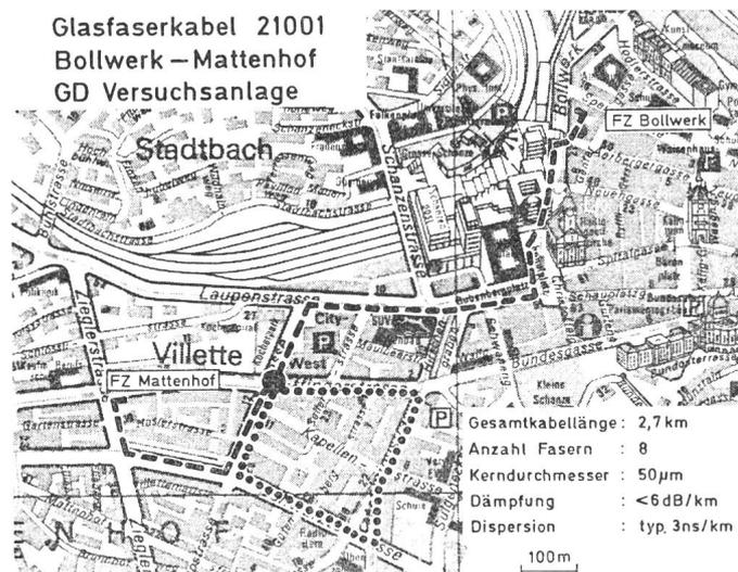
Fig. 1 Topologischer Plan der Anlage
