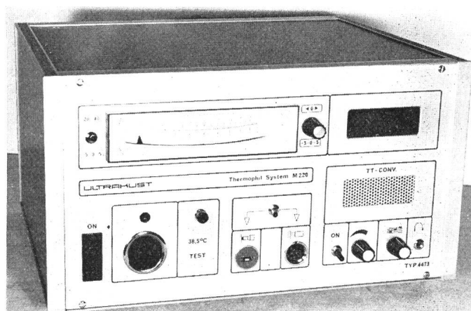
Fig. 3 Ansicht eines IR-Messgerätes mit wahlweisem Anschluss einer Kontaktsonde oder einer berührungslosen Sonde
