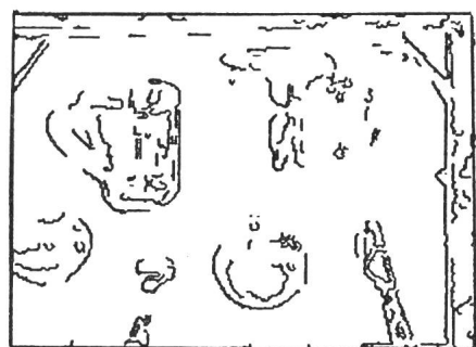
Fig. 11 Image de la figure 9 sur laquelle une poursuite des contours avec élimination des segments de moins de 5 points à été pratiquée
