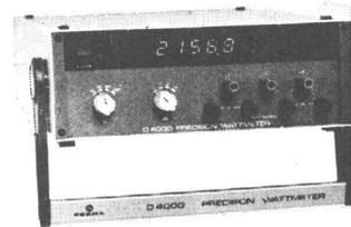
Direktanzeigendes Präzisions-Wattmeter zur Messung der Wirkleistung und Blindleistung in
