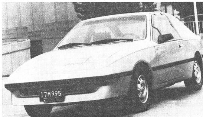
Fig. 1 Das elektrische Vier-Personen-Testauto ETV-1
