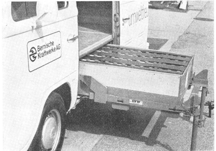
Fig. 2 Batterieeinschubeinheit des VW-Transporters der BKW
