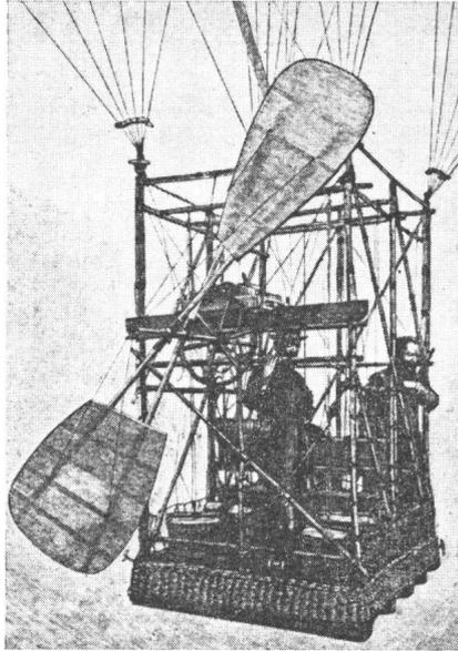
«Auf dem Boden der Gondel stehen mit doppeltchromsaurem Kali gefüllte Tonnen, die mit einer höher stehenden Batterie in Verbindung gebracht sind. Die Batterie ihrerseits speist eine kleine über der Schraubewelle angebrachte Kraftmaschine. Diese macht 1200 Umdrehungen in der Minute und ist mit der leichten Schraube durch ein Getriebe dergestalt verkoppelt, dass sich die Schraube zehnmal langsamer dreht»
