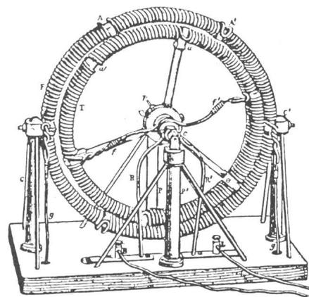
Fig. 18 P. Elias' Motor mit Ringanker, 1840 [10]
