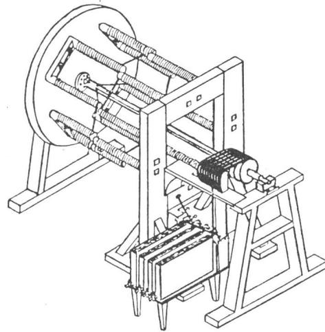
Fig. 8 M. H. Jacobis Motor für Bootsantrieb, 1834 [1]
