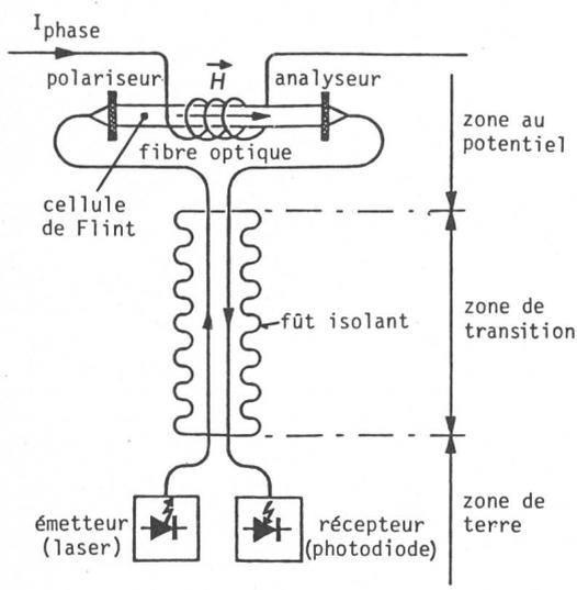
Fig. 1 Transformateur de courant à effet Faraday
