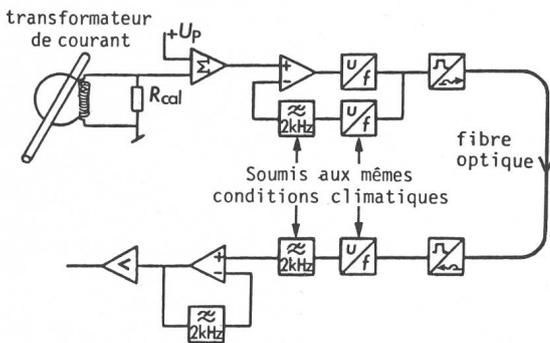
Fig. 2 Bloc diagramme d'un transformateur de courant à capteur actif et transmission par modulation de fréquence à l'aide de fibres optiques
