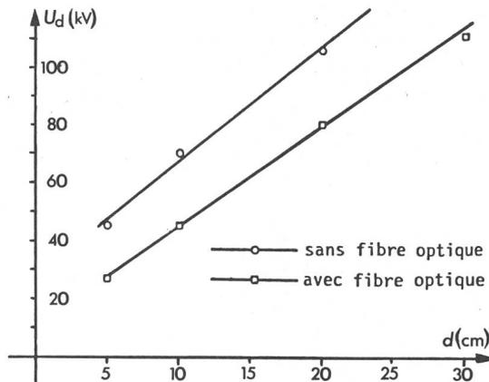
Fig. 5 Rigidité diélectrique  $U_d$  d'un espace d'air à 50 Hz, sans et avec fibre optique
