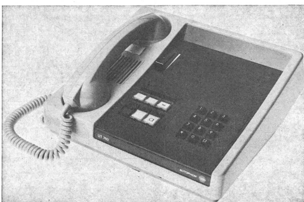
Fig. 2 Universaltelefon mit eingebautem Mikroprozessor
