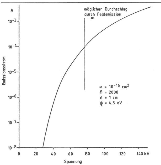
Fig. 1 Stromspannungscharakteristik einer Vakuumisolerierstrecke unter für Vakuumrichter typischen Bedingungen
