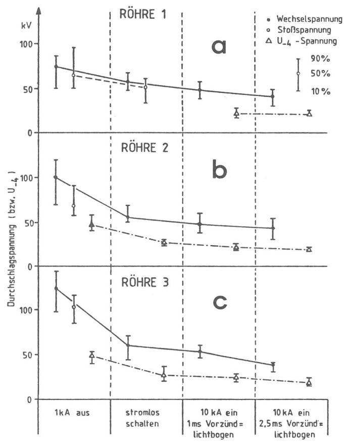
Fig. 2a-2c Durchschlagspannungen und  $U_{-4}$ -Spannungen von verschiedenen Vakuumrichter-Röhren nach Ausschaltlichtbögen, stromlosem Schalten und Einschalten verschiedener Ströme, gefolgt von stromlosem Öffnen (Scheitelwerte) Cu/Bi-Kontakte, Kontaktdistanz 10 mm
