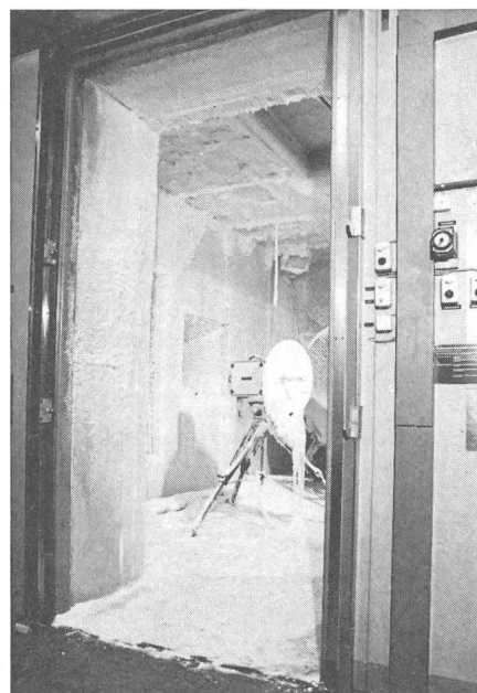
Fig. 2 Vereisungsversuch während der Auftauphase
