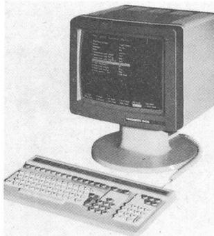
Das Gerät verfügt über eine RS-232-(V24)-Schnittstelle und einen separaten Hardcopy-Port. Nebst Standard-Teletype sind Anschlüsse an NCR, DEC (VT-100) und Honeywell realisiert, weitere sind in Vorbereitung. (Kontron AG, Datasystems, 8048 Zürich)
