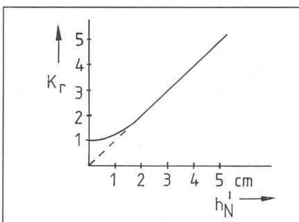
Fig. 3 Widerstandserhöhung durch Stromverdrängung beim Hochstab
