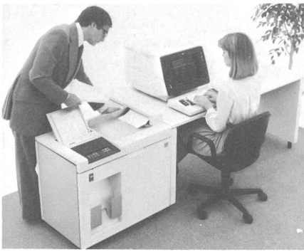
Fig. 2 Bildverarbeitung: links das Bildterminal, rechts das Bildschirmterminal
