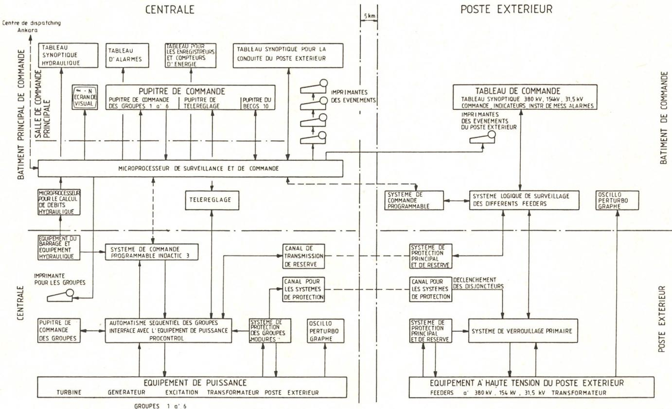
Fig. 2 Configuration générale du système de conduite
