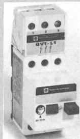
sen auf 25 A/380 V erweitert worden. Das hohe strombegrenzende Schaltvermögen von 6 kA/380 V wird durch einen Is-Begrenzer GV1-L, der sich an die Geräte von 10 bis 25 A anbauen lässt, auf 50 kA/380 V bei  $\cos\phi = 0,7$  erhöht. Die Eigenkurzschlussfestigkeit steigt auf 25 A, wodurch die Notwendigkeit einer Absicherung auch im höheren Leistungsbereich entfällt.
