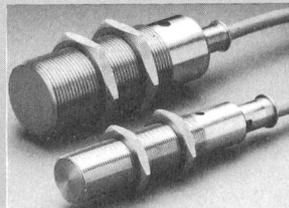
Schaltabstand lieferbar. Die Versorgungsspannung beträgt 10-30 V. Der Ausgang ist kurzschlussfest und mit 200 mA belastbar. Serienmässig ist eine LED für den Schaltzustand eingebaut. Zusätzlich ist ein Anschlussstück für Kabelschutzhaut integriert. Abmessungen und Anschlussbelegung entsprechen den Europeanormen.
