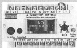
liertes Netz. Die Trennung erfolgt durch entsprechende Isolier-Trenntransformatoren. Die Schutzwirkung beruht auf der Tatsache, dass sowohl bei der Berührung einer Phase als auch bei der Berührung eines unter Spannung stehenden Anlageteiles kein gefährlicher Berührungsstrom zum Fließen kommt. Das Isolationskontrollgerät 107 TM 40 überwacht während des Betriebes den Isolationszustand des Netzes gegen den gemeinsamen Schutzleiter bzw. Erde und meldet im Fehlerfall den Erdschluss op-
