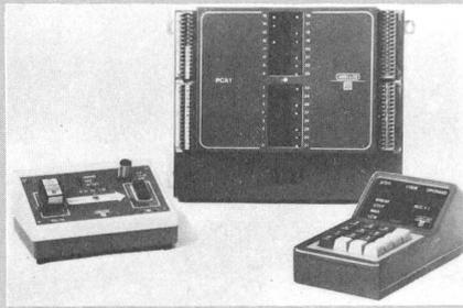
Die Typenreihe PCA 13 weist eine auf 2-K-Worte verdoppelte Speicherkapazität auf. Die Anzahl Ein-/Ausgänge wurde auf maximal 112 erhöht. Mit einem analogen Ein-/Ausgangs-Modul sind nebst Steuerungsaufgaben auch Grenzwertüberwachungen und Regelungen mög-
