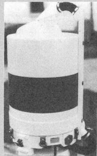
Das Gerät besteht aus der Send-Empfangs-Einheit für Freiluftaufstellung und einer separaten Steuer- und Recheneinheit mit Anzeigefeld und Kurvenschreiber. Es entspricht den Sicherheitsnormen für lange Wartungsintervalle. Ein automatischer Lüfter hält das Schutzfenster der Send-Empfangs-Einheit auch bei schwierigen Witterungsverhältnissen frei von Regen oder Schnee. Selbstprüf- und Störungsanzeigen sind eingebaut. (Asea AG, 8048 Zürich)
