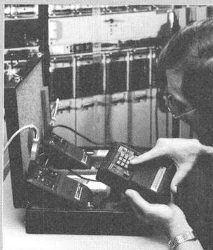
Die kompakte, auch mit Batterien betreibbare Sprecheinrichtung enthält ausser dem eigentlichen Sprech- und Mithörteil (Mikrofon und Lautsprecher) auch eine Wähltastatur, die den Betrieb als Fernsprechapparat ermöglicht. Folgende Betriebsarten sind vorgesehen:
